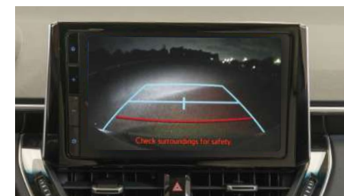
Monitor con cámara de estacionamiento.
